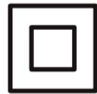
Ze względu na bezpieczeństwo użytkowników niniejsze urządzenie zostało wyposażone w podwójną izolację. **CE**
